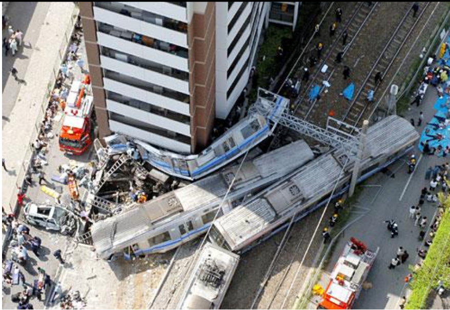
JR西日本福知山線脱線事故、2005-4-25、9:46 アルミ製車両「くの字」に折れ曲る、尼崎市(asahi.com.より)
